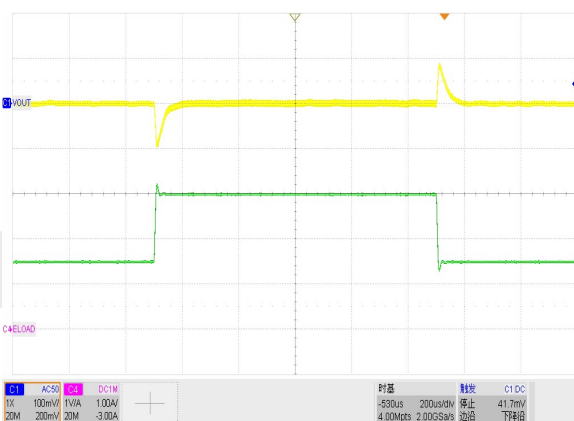
图 14. V_{OUT} = 1.2V , I_O = 1.5A 至 3A , PWM 模式
