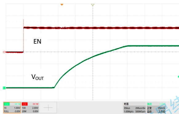
图 21. 软启动, V_{IN}=4.3V , V_{OUT}=3.6V , I_{OUT}=200mA
