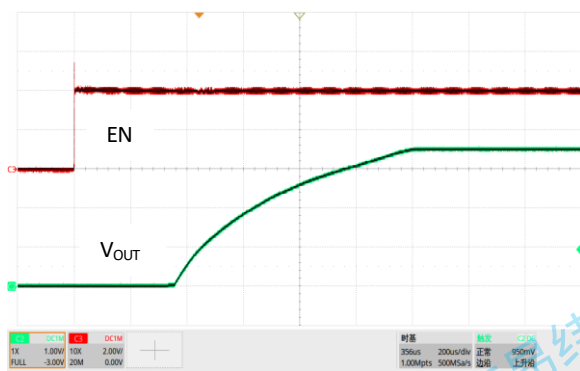
图 21. 软启动, V_{IN}=4.3V , V_{OUT}=3.6V , I_{OUT}=200mA
