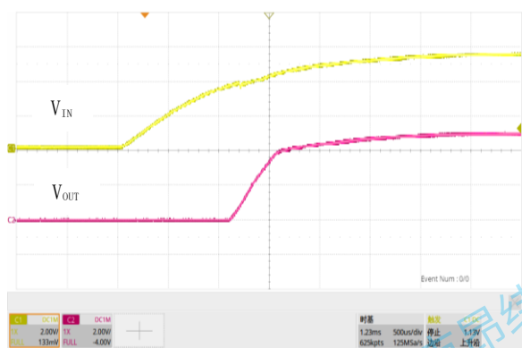
图 17. 软启动, V_{IN}=5.5V , V_{OUT}=5.0V , I_{OUT}=2A
