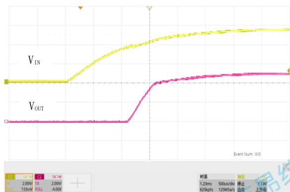
图 18. 软启动, V_{IN}=5.5V , V_{OUT}=5.0V , I_{OUT}=0.5A
