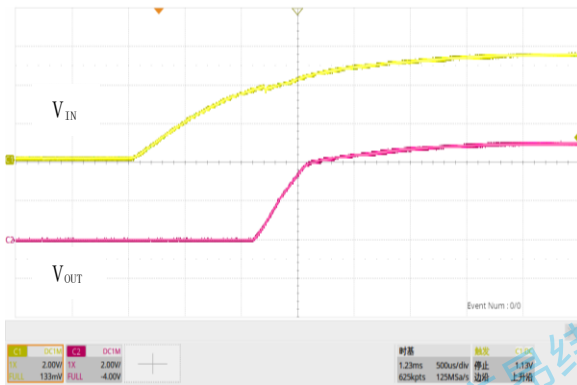
图 18. 软启动, V_{IN}=5.5V , V_{OUT}=5.0V , I_{OUT}=3A
